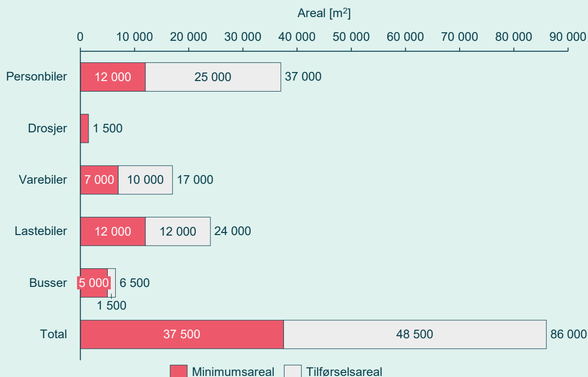
Figur 25: Estimert fremtidig arealbehov for hvert transportsegment og totalt i Oslo i 2030. Minimumsarealet tilsvarer nødvendig areal for selve ladingen og manøvrering ut og inn av ladeplassen, og tilførselsarealet er arealet nødvendig for tilførselsveier. Disse arealene summert tilsvarer totalarealet beskrevet i del 4.3.
