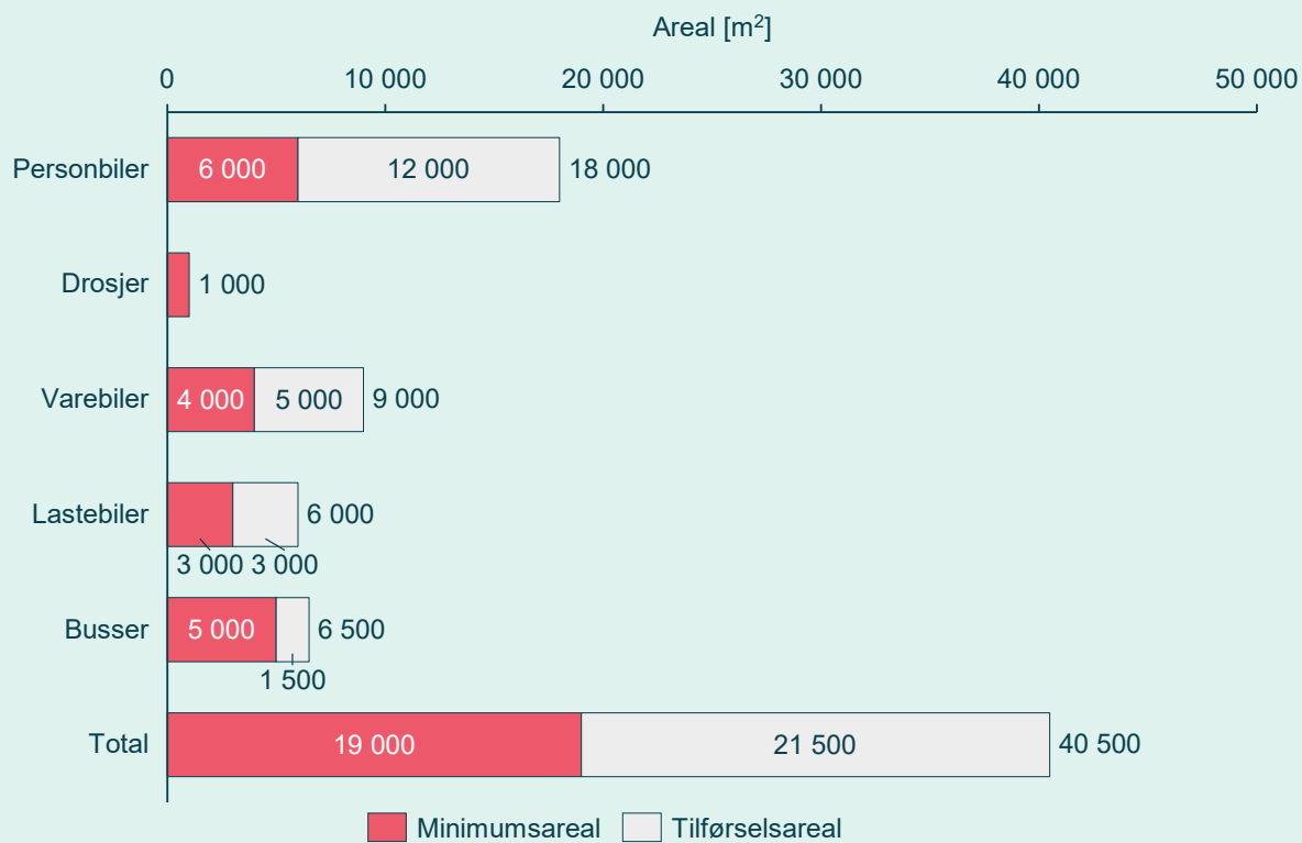
Figur 33: Estimert fremtidig arealbehov for hvert transportsegment og totalt i Oslo i 2030. Minimumsarealet (i rødt) tilsvarer nødvendig areal for selve ladingen og manøvrering ut og inn av ladeplassen, og tilførselsarealet (i grått) er arealet nødvendig for tilførselsveier. Det er antatt en dobling av antall ladepunkter per ladestasjon sammenlignet med beskrivelsene i Tabell 8.
